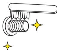
ディスクホイール取付面、ホイールナット当たり面、ハブ取付面(ISO方式では、ハブのはめ合い部も)、ホイールボルト、ナットの錆やゴミ、泥、追加塗装などを取り除きます。
