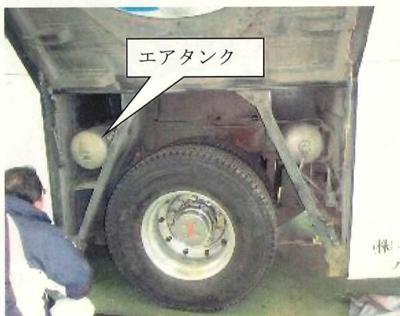
写真6 後輪ブレーキ用左側エアタンク
